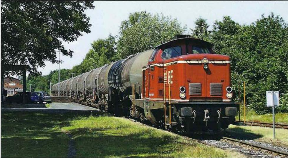
Abb. 2: Kesselwagenzug der BE. Erdöltransporte sind ein traditionsreiches Transportgut der BE. Bei der Lok D 21 handelt es sich um eine ehemalige V 100 der Deutschen Bundesbahn.
